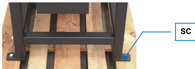
III. 9 : Fixation sur la palette de transport
