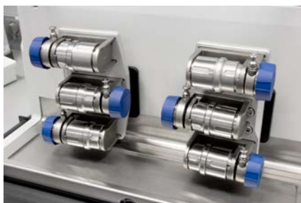
Puestos de molienda del MM 500 vario
