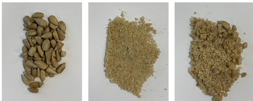
Abb. 1a: Sonnenblumenkerne: Originalprobe (links), optimal vermahlen mit einer ZM 300 und einem 4 mm Ringsieb (mitte) und zu grob vermahlen mit einer GM 200 (rechts).
