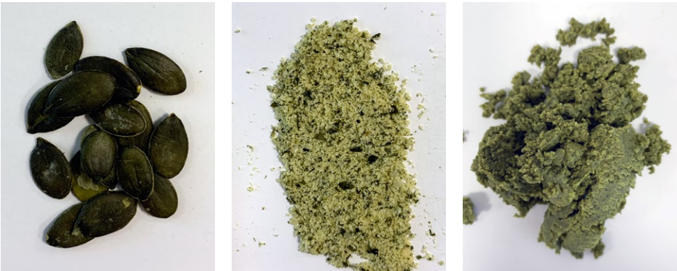
Abb. 4a: Kürbiskerne: Originalprobe (links), optimal vermahlen (Mitte, GM 200) und übermahlen (rechts, GM 200).
