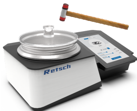
Fig. 11: Picchiare con il martello morbido.
