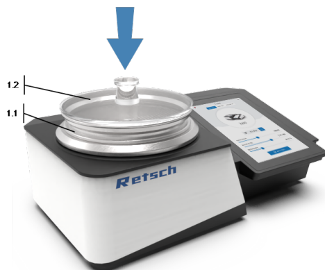
Fig. 9: Applicazione del coperchio del setaccio
