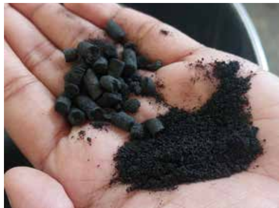
Abb. 4: links: Injektion der Pflanzenkohlesuspension mit Geolinjector (Vogt GmbH, Weidenberg, Deutschland). rechts: Ungemahlene und mit der HM 200 auf <2\text{ mm} gemahlene Pflanzenkohle
