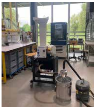
Abb. 5: links: Aufbau der HM 200 mit Zyklon rechts: Pflanzenkohle-basiertes Düngergranulat.
