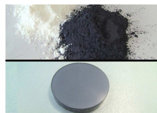
FeSiMg-Granulát 12 g plus 2 g licowax Veľkosť častíc 0.10 mm Lisovací nástroj 40 mm Hliníkové pohárky 60 s 15/25/35 ton
