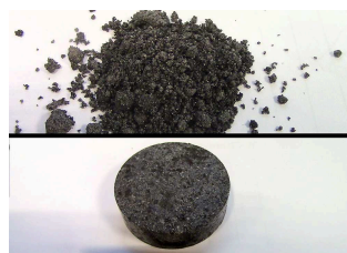
Troska 40 g Veľkosť častíc 0,25 mm Lisovací nástroj 40 mm 20 s 20 ton
