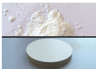
Celulóza 7 g Veľkosť častíc 0.15 mm Lisovací nástroj 40 mm Hliníkové pohárky 40 mm 30 s pri 10/20/30 tonách
