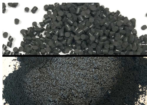
Rychlé mletí černé Fluorcarbonové gumy (FKM) zkřehnutím vzorku ve dvou 125 ml nádobách při -100 °C.
