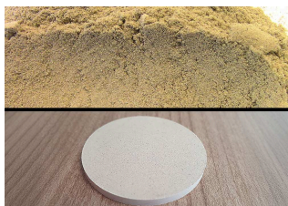
Dřevo 4 g Velikost částic 0,25 mm Lisovací nástroj 32 mm 20 s při 10/20/30 tunách
