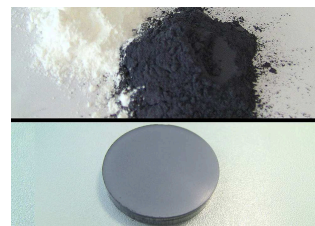
FeSiMg-Granulát 12 g plus 2 g liowaxu Velikost částic 0.10 mm Lisovací nástroj 40 mm Hliníkové poháry 60 s 15/25/35 tuny
