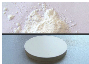
Celulóza 7 g Velikost částic 0.15 mm Lisovací nástroj 40 mm Hliníkové poháry 40 mm 30 s při 10/20/30 tunách
