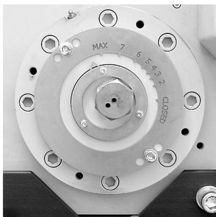
Skala do płynnego ustawienia szerokości szczeliny
