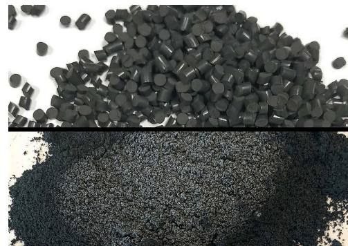
두 개의 125 ml 용기에서 -100 °C로 시료를 취화하여 검은색 탄화 플루오르 고무를 빠르게 분쇄합니다.
