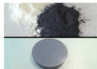
硅镁铁颗粒 12 克加地衣蜡 2 克 粒径 0.10 毫米
