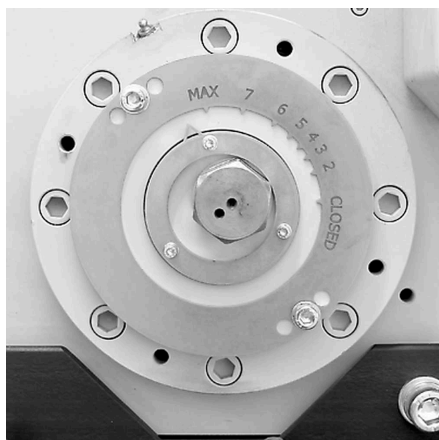
Scala per l'impostazione continua della larghezza della fessura
