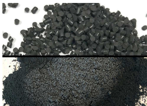
Macinazione rapida di Elastomeri fluorurati (FKM) mediante infragilimento del campione in due giare da 125 ml a -100 °C.
