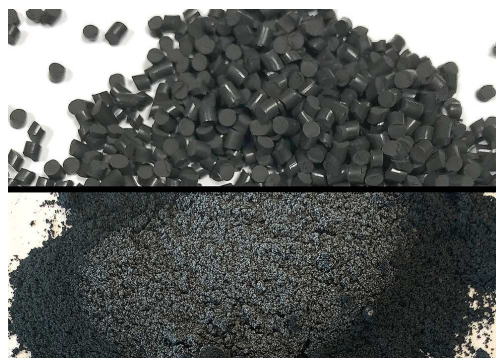
Molienda rápida de caucho negro de flurocarbono (FKM) mediante la fragilización de la muestra en dos recipientes de 125 ml a -100 °C.
