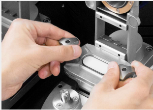
INSERTION DU BOL DE BROYAGE
