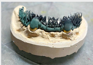
Oxidschicht auf einem Modellteil vor dem Sandstrahlen
