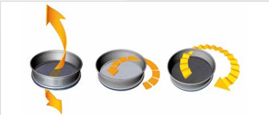
Abb. 2: Prinzip der Wurfsiebung (links), Plansiebung (Mitte) und Klopfisiebung (rechts).
