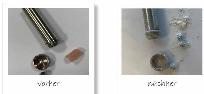
Abbildung 4: Homogenisierung einer gefrorenen Gewebeprobe in der MM 500 control bei -60 °C.
