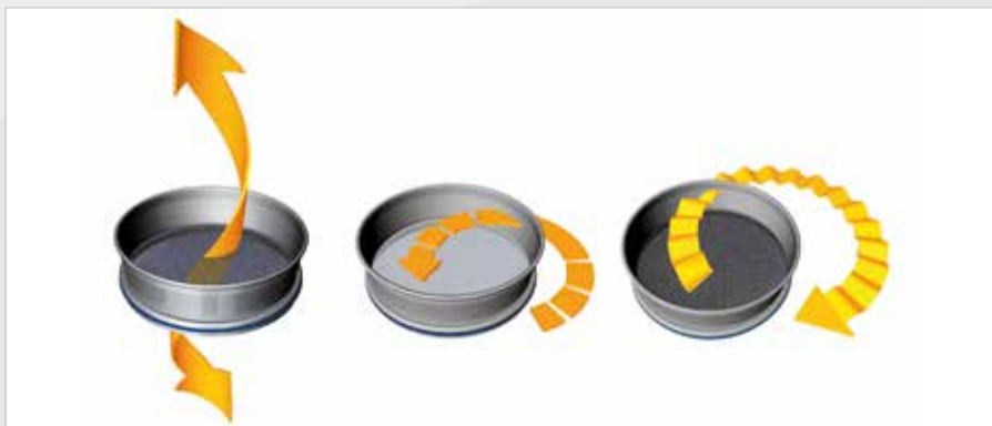
Fig. 2: Tipo de movimiento realizado en el tamizado tridimensional (izq.), el tamizado horizontal (centro) y el tamizado por golpeo (der.).
